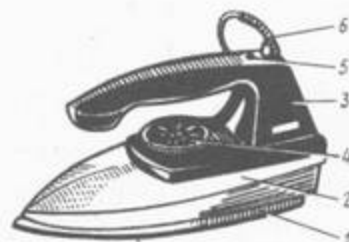
Рис. 6. Электроутюг с терморегулятором: 1 — подошва, 2 — корпус, 3 — ручка, 4 — терморегулятор, 5 — сигнальная лампочка, 6 — шнур с вилкой
